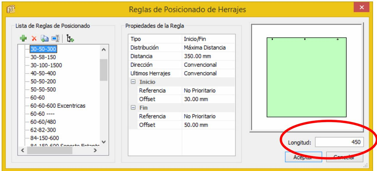
Nota 1: En la ventana de definición de la Regla verificamos que para una profundidad de 450mm se añade un Tornillo central.
