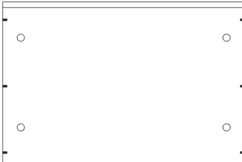
Observemos que para los centros de los 4 taladros, las distancias de 100mm (de la Regla de Posicionado) son hasta cantos frontal y trasero y la distancia de 50mm (Posición Y en la definición del Herraje Pata) es hasta le canto lateral.
